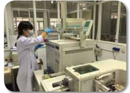
Phòng R&D được trang bị máy HRGC/HRMS độ phân giải cao, chuyên phân tích mẫu dioxin. Ảnh: VN.
