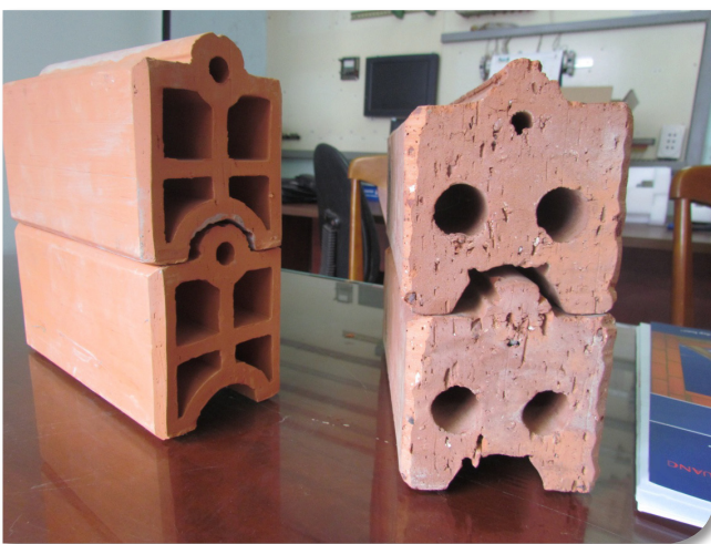
Cấu trúc của viên gạch xây âm dương sản xuất tại Nhà máy Tuynel Việt Tiến Hòa Bình và Gạch Đồng Nai. Ảnh: H.M.
