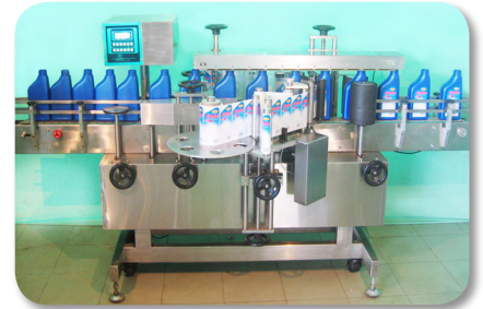
Máy dán nhãn 2 mặt, một trong những sản phẩm ứng dụng bộ điều khiển số của Công ty A.K.B. Ảnh: YL.
