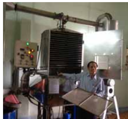
TS. Vũ Kế Hoạch (chủ nhiệm đề tài) thuyết minh về hệ thống buồng sấy của máy sấy đa năng các sản phẩm ong mật. Ảnh: VN.
