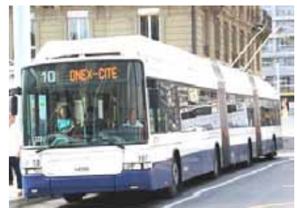
Trolleybus 2 khớp nối chở được 180-240 khách.
