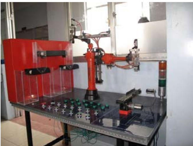
Mô hình tay gắp – băng tải phân loại sản phẩm
