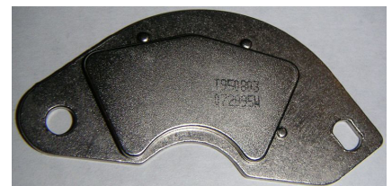
Nam châm NTĐH NdFeB (neodymium) được sử dụng trong ổ cứng máy tính.
