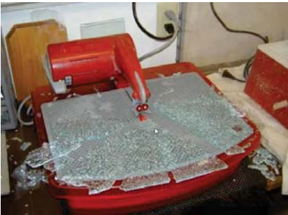
Kính đã gia nhiệt không thể khoan cắt vì rất dễ vỡ nguyên tấm
