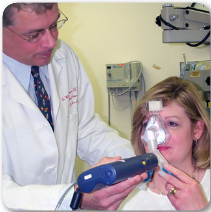
Sử dụng mũi điện tử để phân tích hơi thở của bệnh nhân
