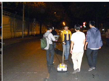
Tìm kiếm hố tử thần bằng radar xuyên đất trên đường Hai Bà Trưng, Q.1, Tp.HCM
