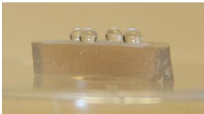
Thí nghiệm khả năng “Tự làm sạch” của SLIPS: khi nhỏ vật liệu SLIPS trong suốt lên, các chất bẩn sẽ bị “gom” lại và nhanh chóng trượt khỏi bề mặt màu vàng
