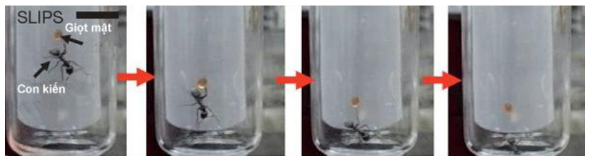
Con kiến và giọt mật bị trượt xuống thành bình có phủ SLIPS. (Thông thường, kiến có thể bám và di chuyển rất tốt trên bề mặt chống dính cực tốt như teflon).
