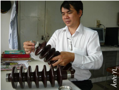
ThS. Trần Đình Hiến giới thiệu sản phẩm sứ tụ điện đã được phủ lớp hợp kim trung gian
