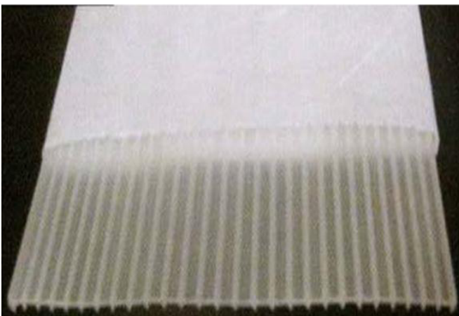
Công nghệ bắc thấm đúng được đề tài đề xuất cho việc xử lý nền móng bãi chôn lấp tại Củ Chi.
