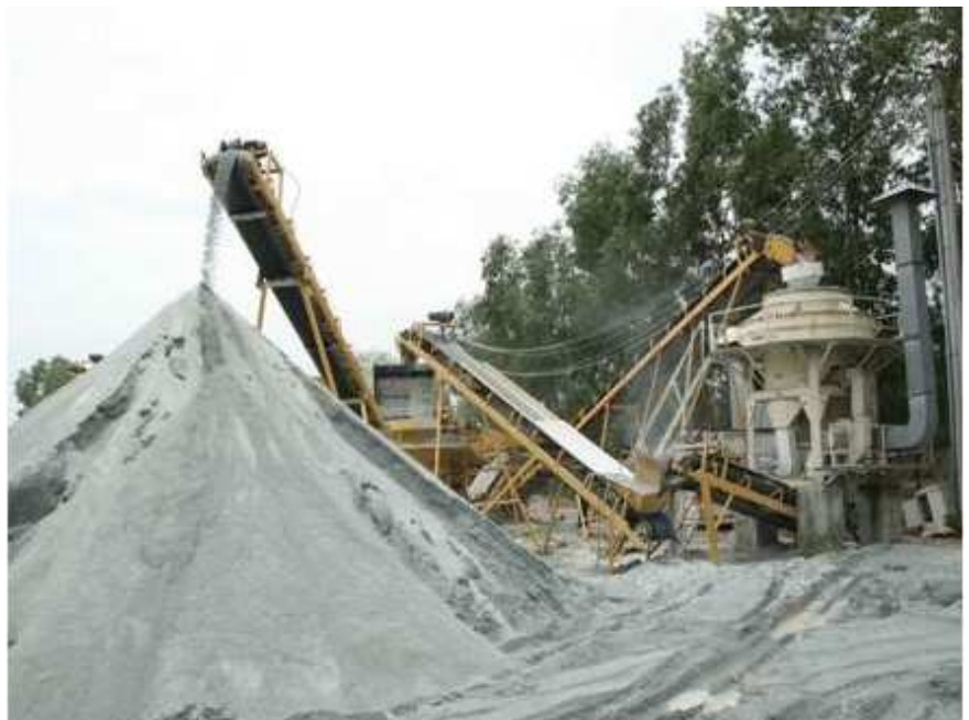
Máy nghiền cát Titan D-160 lắp đặt tại mỏ đá Tân Đông Hiệp (Bình Dương) và sản phẩm cát nhân tạo
