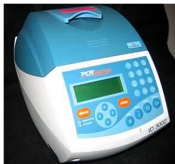
Máy PCR có 1 buồng phản ứng tự động thay đổi nhiệt độ
