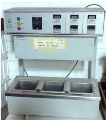
Máy PCR "đời đầu" với 3 bể nhiệt riêng chưa có buồng phản ứng tự động
