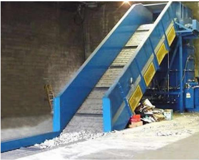
Hệ thống băng tải nghiêng thiết kế cho Cty TNHH SX-TM giấy Thiên Trí (Tp.HCM) giúp giảm diện tích mặt bằng và tăng hiệu suất sản xuất.
