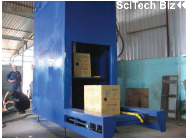
Hệ thống băng tải thùng lên lầu thiết kế cho Cty TNHH nhựa APPC (Long An). Đây là một kiểu băng tải mới chiếm mặt bằng ít, vận chuyển theo phương thẳng đứng để đưa các loại hàng hóa có tải trọng lên đến 100kg một cách an toàn và liên tục.
